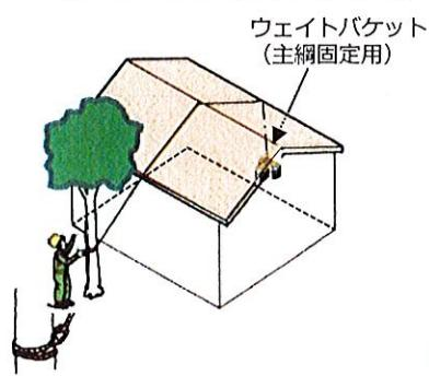
3 スライドを主綱に連結し、はしごを昇り屋根上に上がり、屋根棟付近で安全ブロックを主綱に連結する。
