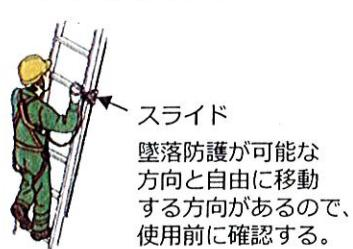
4 安全ブロックのストラップが適切に機能することを確認してから、安全帯のD環へ取り付ける。その後で、スライドをD環から取り外す。
