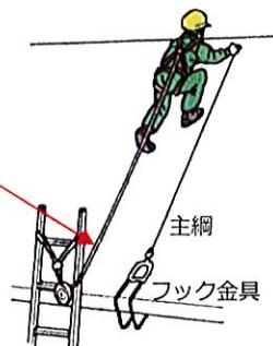
※はしごの踏み桟は墜落阻止するための強度が不十分な場合があるので、落下時の荷重が踏み桟ではなく、支柱に伝わるようとする。
