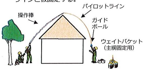
2 パイロットラインと仮固定した主綱を手前側へ引き戻し、屋根上を通した主綱を強固な構造物・樹木などに固定する。
