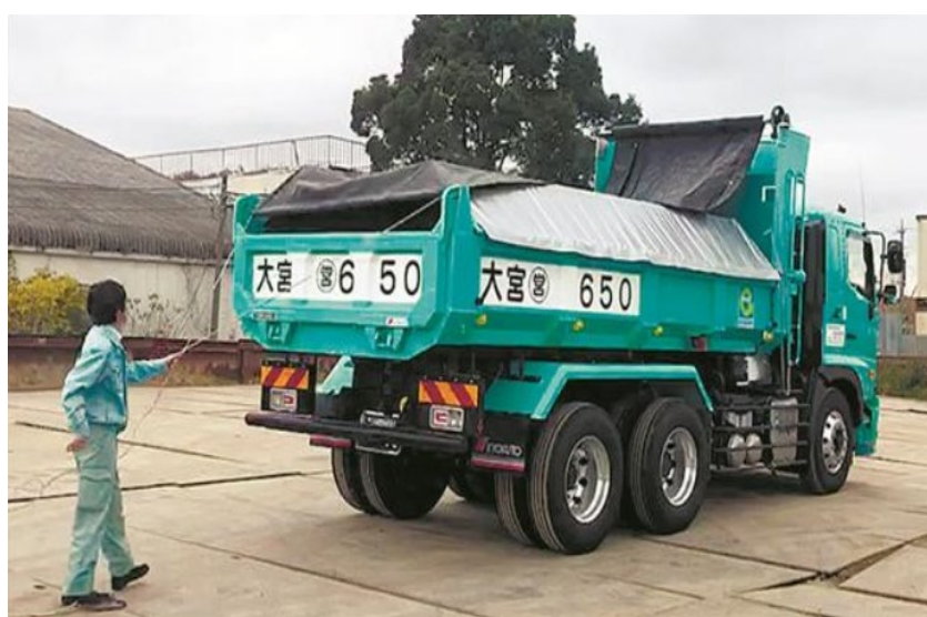
荷台シート手動式巻上装置
